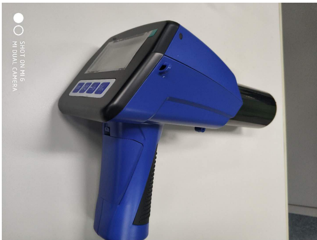
附图 6 天津电装电子有限公司个人剂量报警仪及个人剂量计
