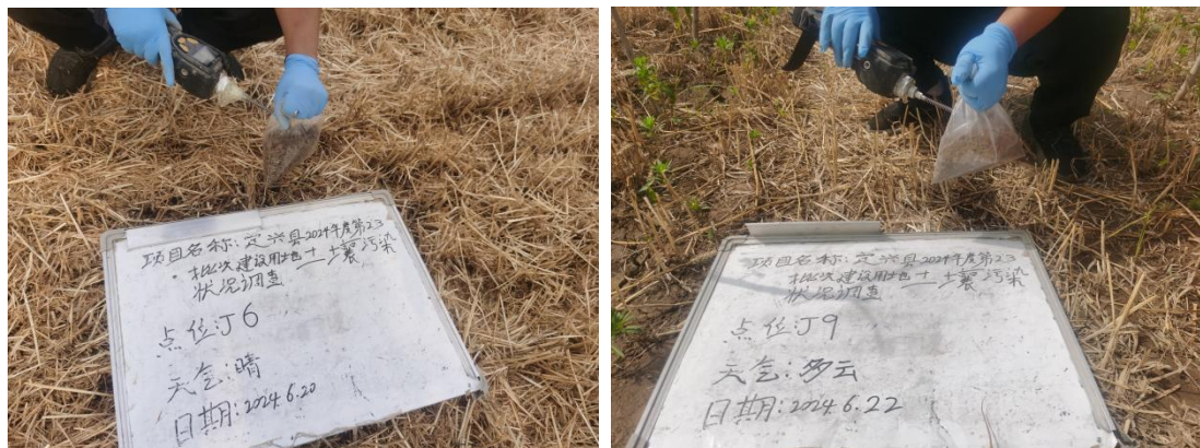
图5-6 PID现场检测
