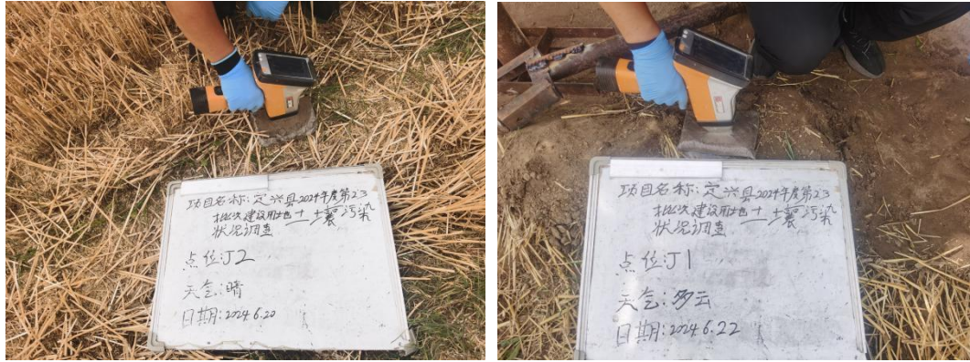
图5-7 XRF现场检测
